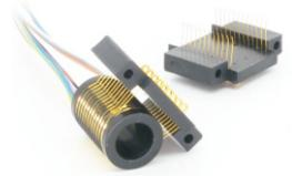
森瑞普S000系列1~48通路分离式滑环，该系列有所有规格，滑环转子部分的孔径从12.7mm到200mm多种可选，通路数（可以通过的电流/信号线的数量）越多，长度越大，详细参考下表。某些设备中需要360度旋转传输各种电流或信号，由于标准过孔滑环尺寸太大，无法安装，S000系列就是用来替代它们的。S000系列分离式滑环包括定子和转子两部分，客户需要分别安装。
